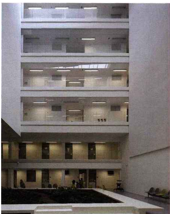
◀ Des calculs ont permis d'établir que la non-protection solaire ne venait pas dégrader l'ambiance thermique intérieure. C'est le vitrage lui-même qui assure cette protection
